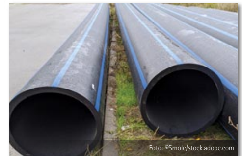
Bild 14: Schwarz eingefärbte RE-Rohre, gekennzeichnet mit königsblauen Streifen für die Trinkwasserverteilung
